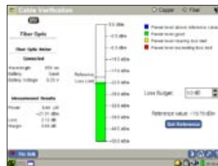
Medición de potencia de la fibra óptica
